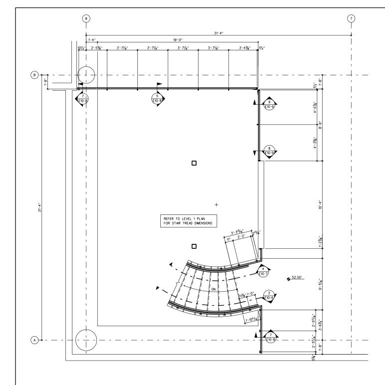
GUARDRAIL PLAN @ CIRCULAR STAIR - LEVEL 3
