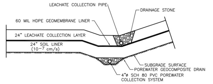
**BASELINER SYSTEM AT TOE OF SLOPE**
