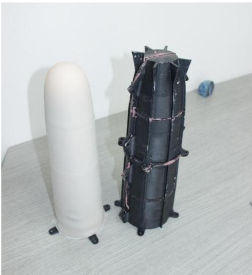
Molde interno con silicona y molde externo
