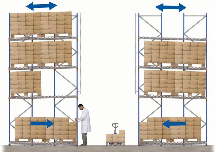
**2** Niveles dinámicos con entrada y salida por el mismo pasillo, que alimentan niveles de picking colocados en su parte inferior. La parte superior de las estanterías del lado del pasillo de picking ha de ir protegida con mallas anticaída. Al igual que en los anteriores dibujos, los palets de los niveles superiores se introducen en los inferiores.
