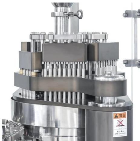
El mecanismo de llenado de polvo patentado incluye varias técnicas patentadas como el depósito de polvo irregular de múltiples superficies, el alimentador en ángulo lateral, etc., lo que hace que el polvo se distribuya uniformemente dentro de la sala de almacenamiento de polvo, fluya correcta y suavemente hacia las cápsulas y logre un extremadamente preciso proceso de llenado de cápsulas.
