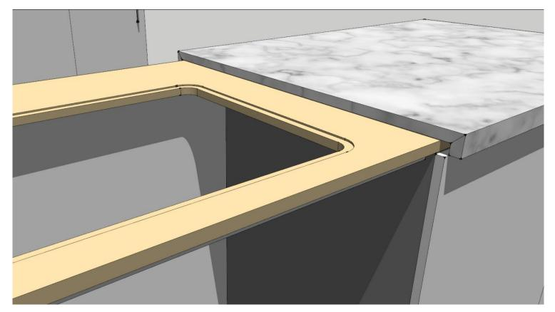
ILLUSTRATION ON HOW THE UNDERMOUNT SINK SITS ON THE BENCH
