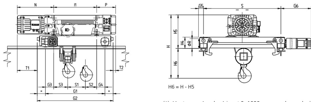
(\*) L'entraxe prévu de série est S=1000 mm, sur demande, il peut être fourni avec un écart S = 1200 mm
