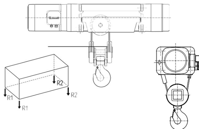
**CHARIOTS MONOPOUTRE DST/N/S POUR PALANS ELECTRIQUES A CABLE DRH - VERSION A 2 BRINS (2/1)**
