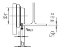
\* R max calculée en considérant un coefficient dynamique de 1.15 et aucun coefficient de majoration "M"
