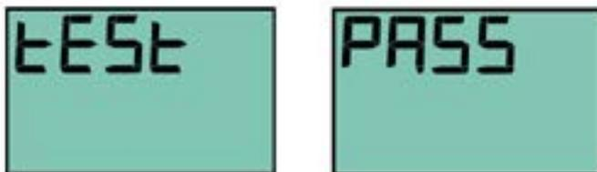
Tras el cambio de batería DIGI 2 efectúa un autotest de presurización para asegurarse de que se ha realizado correctamente.
