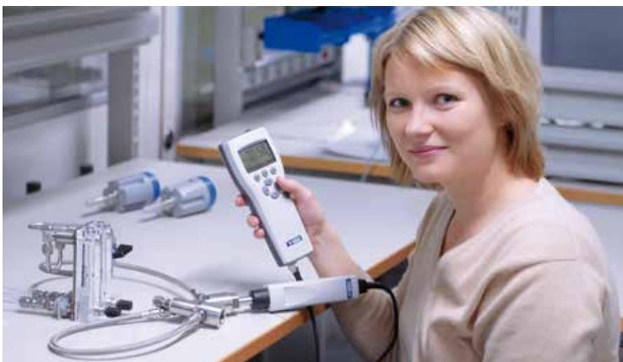
**El medidor portátil DM70** mide el punto de rocío y la temperatura con precisión en un amplio intervalo de medición. La sonda puede insertarse directamente en procesos presurizados de hasta 20 bares absolutos (290 psi) y responde rápidamente tanto en condiciones ambientales como de proceso.
