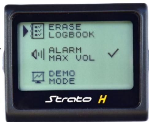
Use BE para navegar pelas opções. A seta à esquerda (▶ seletor) marca a seleção atual. Pressionar BE move o seletor para o próximo ajuste.
