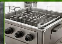
TANQUES DE ULTRASONIDO (FASE VAPOR)
