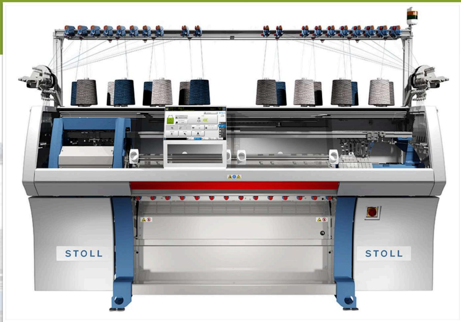
Diese Technik ermöglicht es Strickbekleidung im 3D Verfahren pixel to product herstellen zu können.
