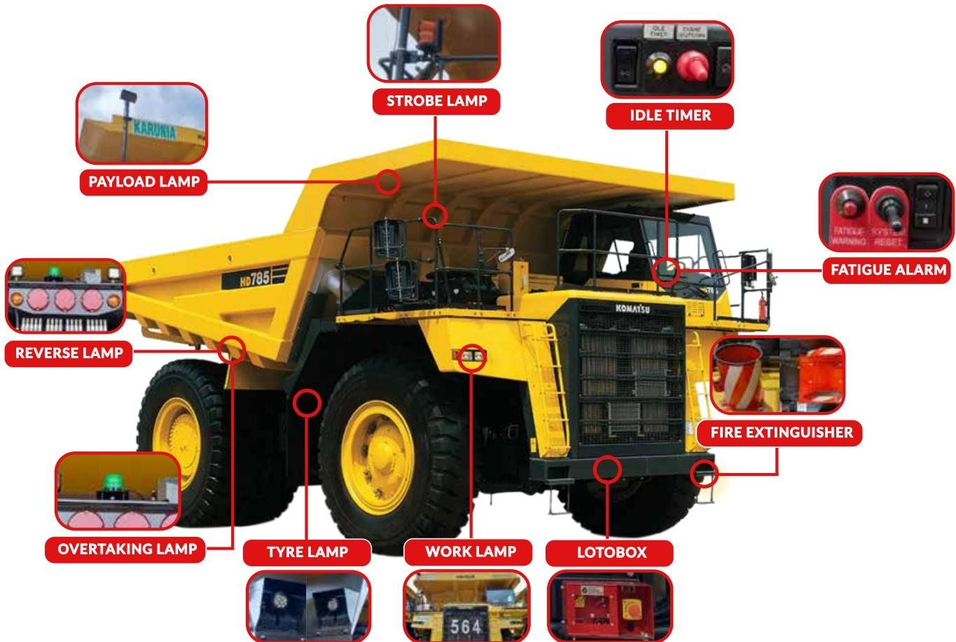
Safety device adalah perangkat untuk meningkatkan keamanan dan keselamatan di berbagai industri seperti konstruksi, pertambangan, transportasi, dan manufaktur. Safety Device yang kami adakan termasuk Lotobox, Beacon, Communication Radio (Icom, Motorola), Idle Timer (RCT), Wheel Chock (Eaton), dan Fatigue Warning (Schneider).
