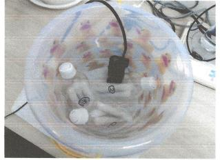
溶存水素計になります。 左側の容器に水を入れて 撹拌して溶存水素を計測します。 なお、撹拌しながら計測となりますので、 溶存水素の値は常に動きます。 その中で判断します。
