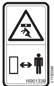
2 VARNING! Gå inte under upplyft redskap (Reservdelsnummer i USA: 11027566)
