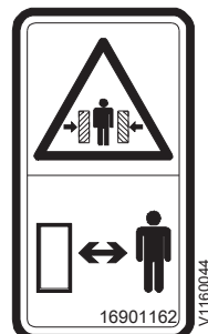
3 VARNING! Klämrisk i ramled vid svängd maskin (Reservdelsnummer i USA: 13935000)
