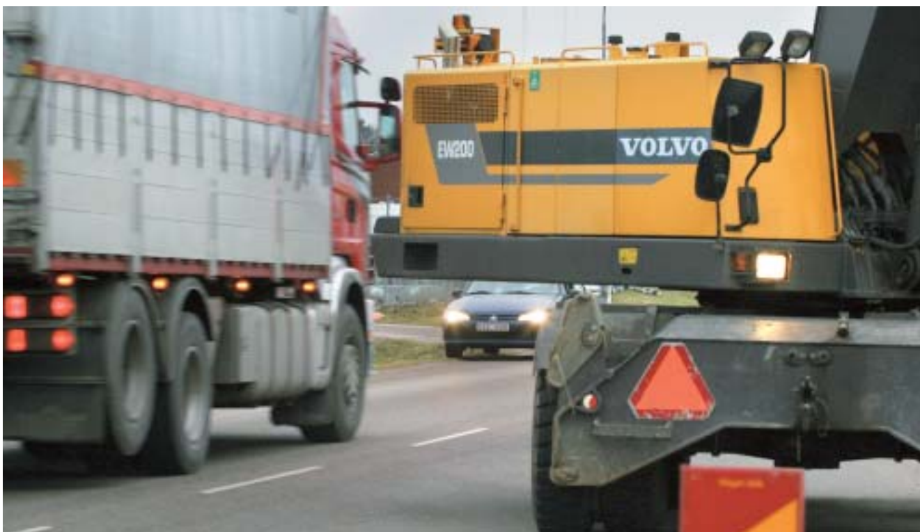
En annan återkommande skada är att någon eller något skadas av maskinens överhäng där bak.
