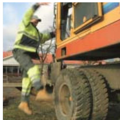
Genom att inte använda maskinens fotsteg ökar risken för olyckor.
