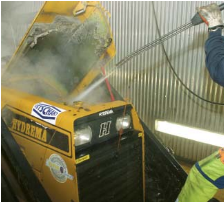
Salt- och smutsavlagringar orsakar på sikt onödiga driftstopp. Därför är det viktigt att hålla motorn ren.
