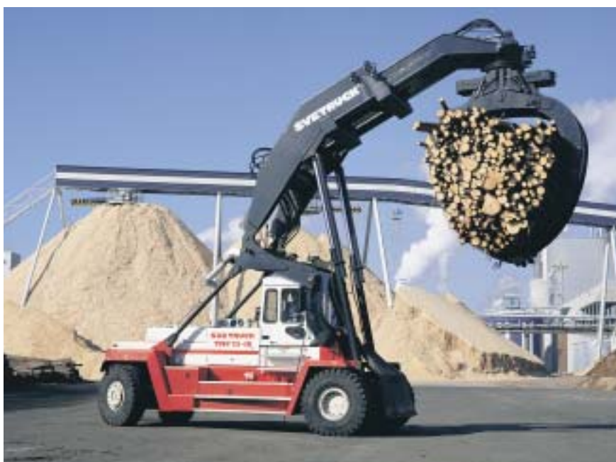
I anläggningsmaskiner som är verksamma i brandfarlig miljö, som exempelvis sågverk, krävs att man har brandskydd i form av fast monterad sprinkleranläggning.
