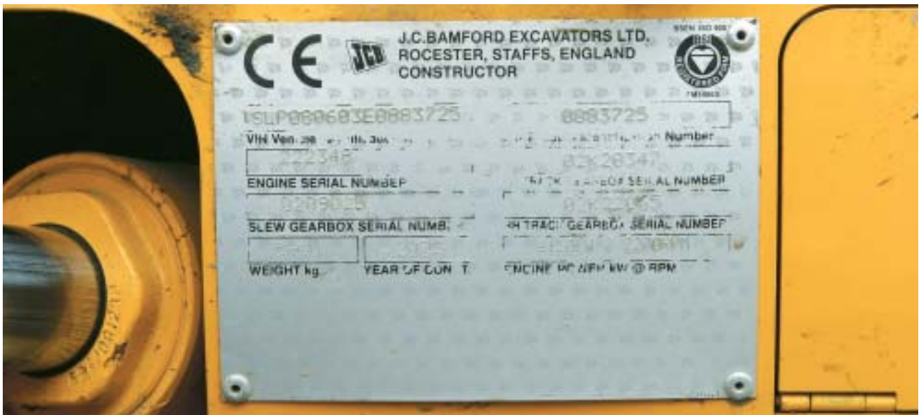
Det är bara maskiner som uppfyller EUs kvalitets- och miljökrav som får CE-märkas. Numera måste alla nya entreprenadmaskiner vara CE-märkta.
