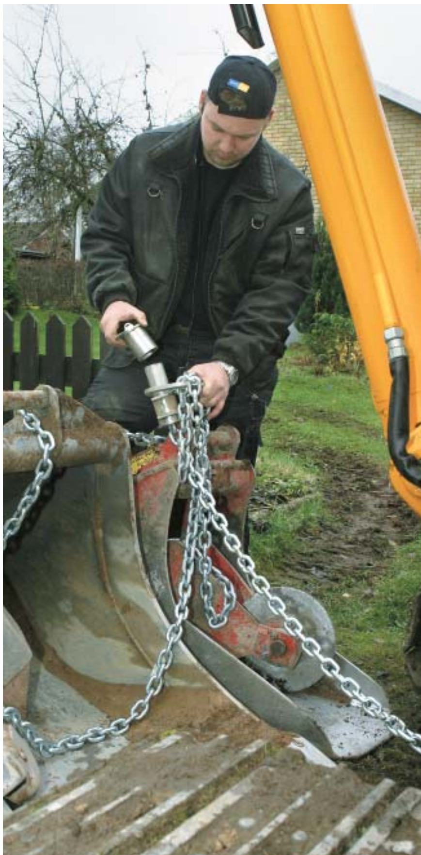
Föremål som skopa, skärare, gafflar och liknande ska vara fastlåsta med stöldskydd godkänt av Länsförsäkringar, det vill säga kätting och lås av minst klass 3. På bilden Goliat redskapslås 2021.
