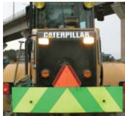
Trafiksäkerheten ökar om reflexer monteras på maskiner, redskap och släpkärror.
