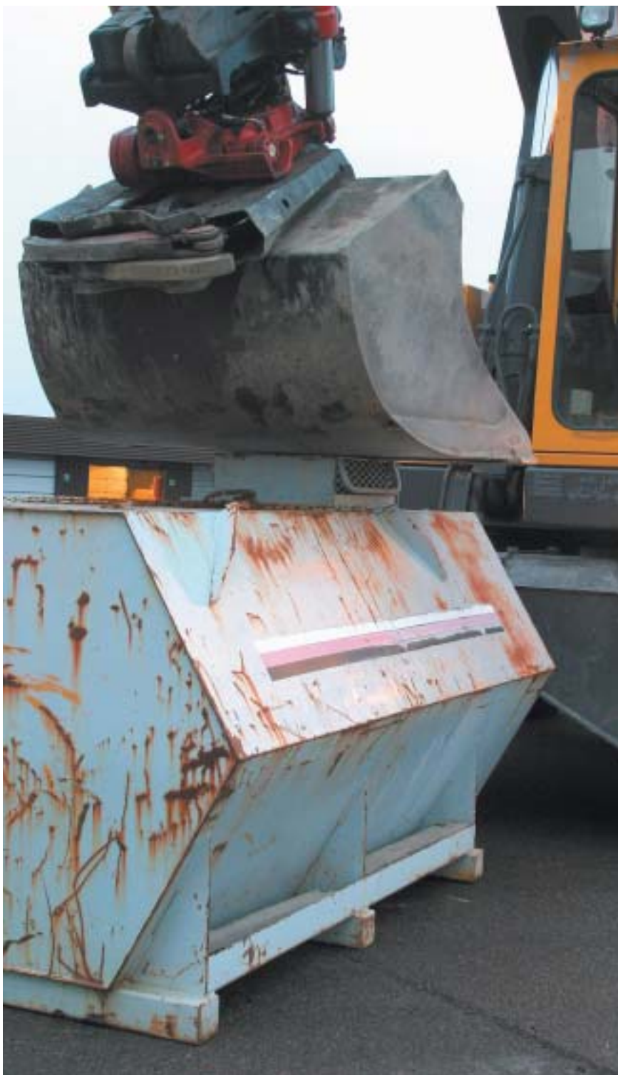
Stöld av diesel vid ensligt belägna arbetsplatser blir allt vanligare. Ett bra sätt att undvika stöld är att låsa farmartanken med hjälp av grävmaskinens skopa, gärna så att skopan vilar över pumplåset.
