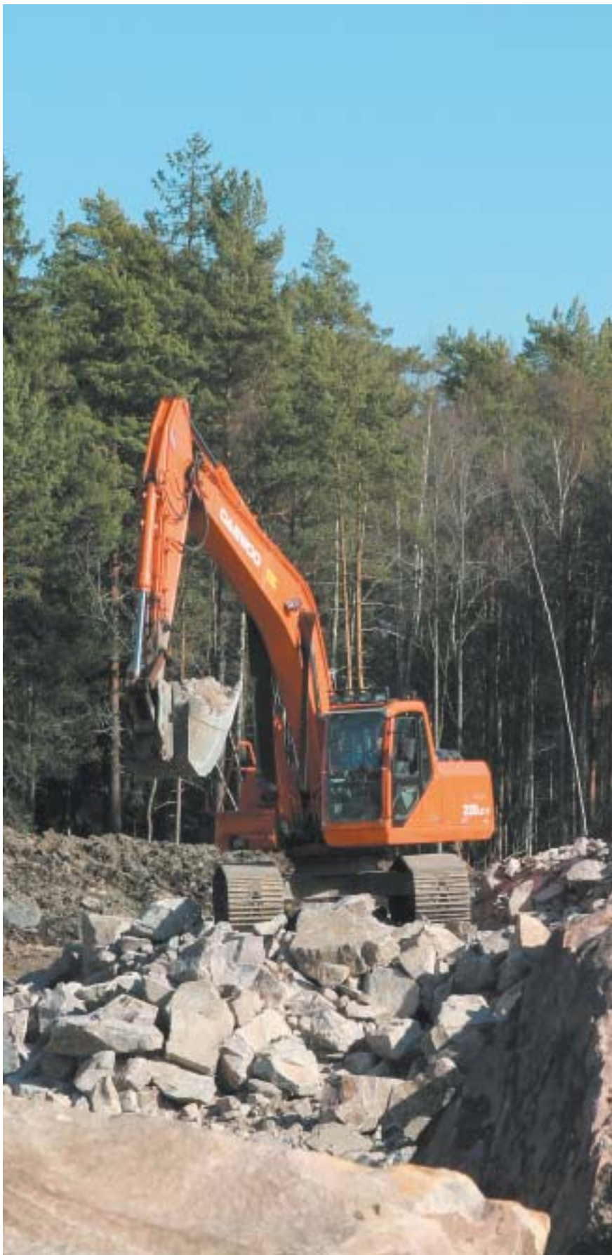
Genom Working Eco Driving är det möjligt att göra en bränslebesparing på cirka 25 procent.
