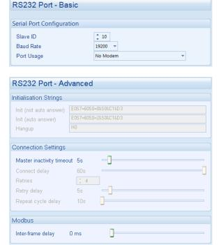
Los ajustes de fábrica son para que el módulo se comunique a 19200 baudios, dirección de esclavo MODBUS 10.
