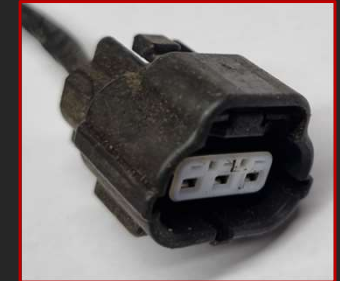
Subaru gear box speed sensor. Only fitted if using Subaru gearbox
