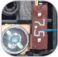
mit gängiger Flachstecksicherung
