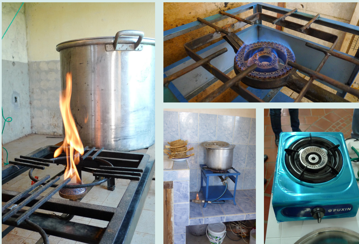
Figura 24: Diferentes tipos de cocina funcionando a biogás.
