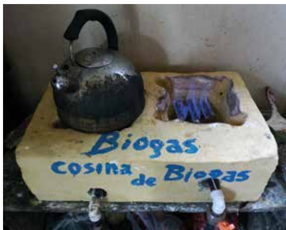
Ilustración 12. Cocina a biogás construida en yeso por el propio usuario, Victor Serrano en la comunidad de Colcapamapa (Tiquipaya, Bolivia).
