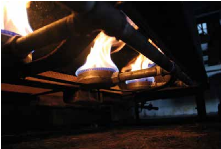
Ilustración 22. Uso productivo del biogas, preparación agua caliente para desplumar pollos -Visita de campo proyecto PREMACA Finca Avícola de Palma.
