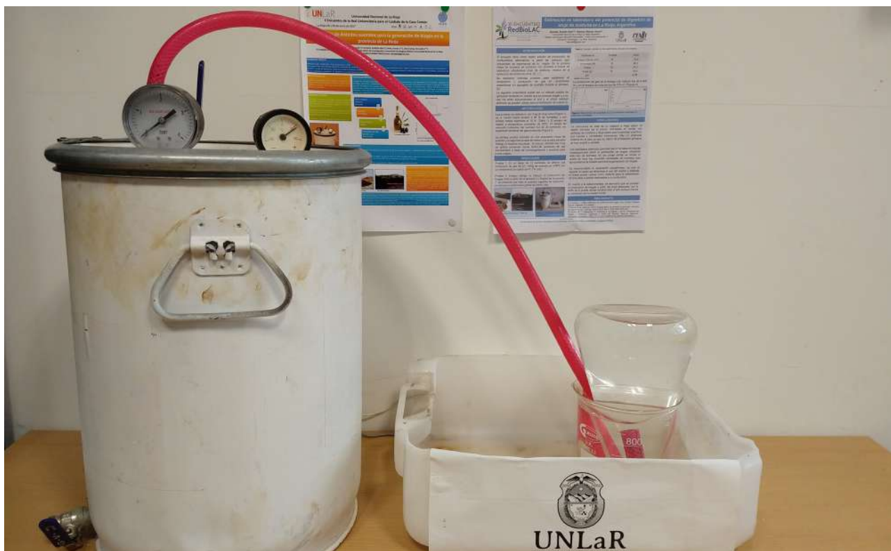
FIGURA 1 | Biodigestor tipo batch a escala de laboratorio. Capacidad 25 litros.
