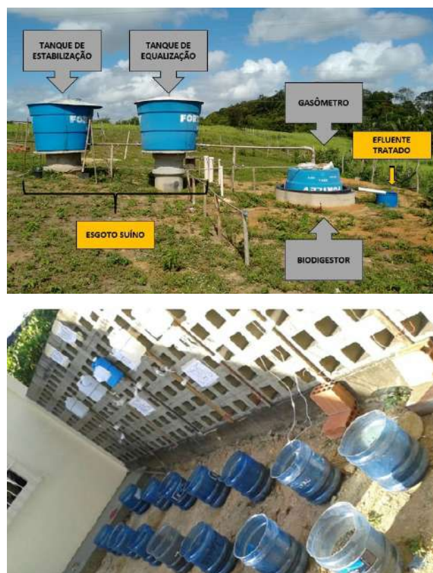
FIGURA 1 | Biosistema integrado (a) e disposição experimental e sistema de fertirrigação por gotejamento (b).
