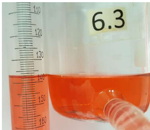
FIGURA 1 | Ecuilibración del nivel (y presión) para lectura del volumen de biogás en eudiómetros.
