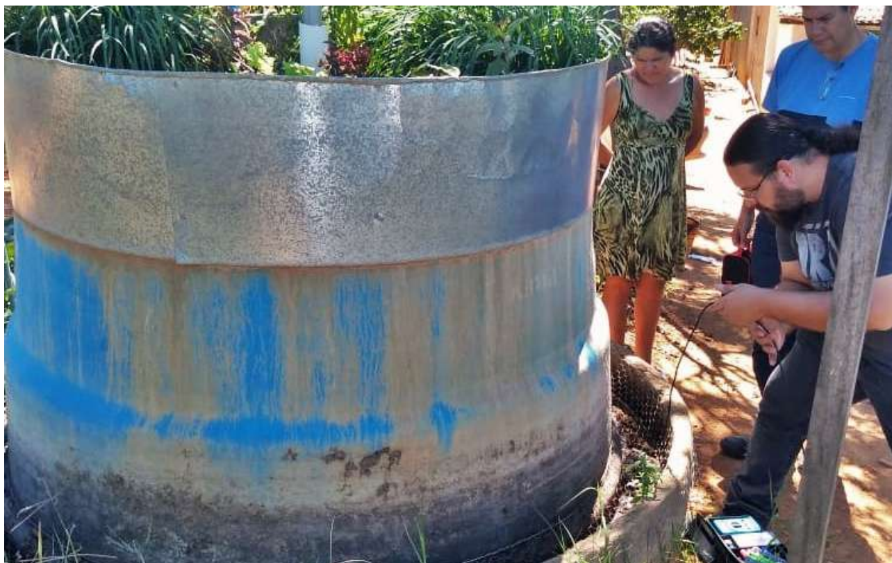
FIGURA 2 | Instalação da sonda de medição de temperatura interna.
