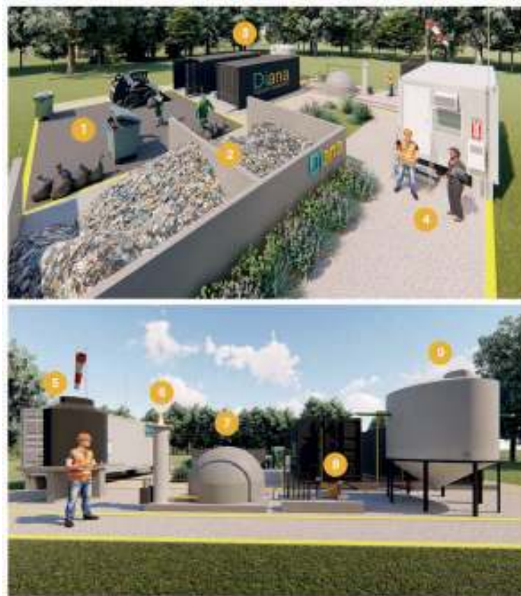
Figura 1 | Componentes principales de la planta piloto. 1: plataforma de manipulación; 2: celdas para disposición de residuos; 3: reactores anaeróbicos; 4: cabina de control con termotanque; 5: tanque de abastecimiento de agua; 6: antorcha de quema; 7: gasómetro; 8: desulfurador; 9: tanque de efluente. Fuente: elaboración propia, 2020.
