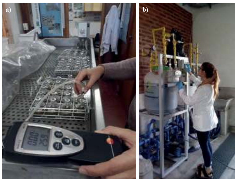
Figura 1 | A: ensayo de producción de biogás en batch en el laboratorio. B: producción de biogás en sistema continuo en planta piloto. Laboratorio de Biomasa y Bioenergía-Unidad Integrada Balcarce (INTA-FCA, UNMdP).
