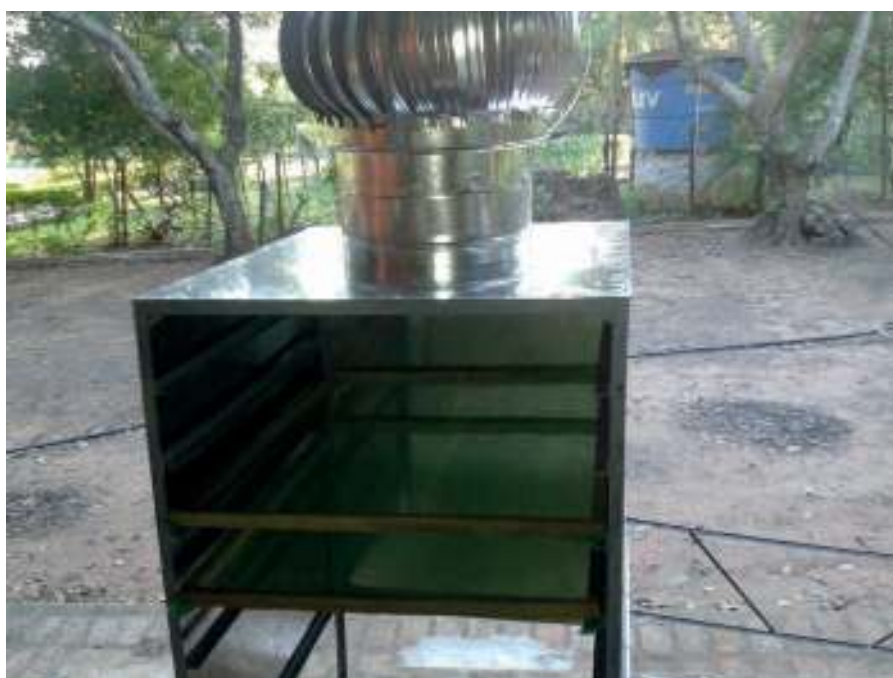
Figura 2 | Compartimientos del deshidratador.
