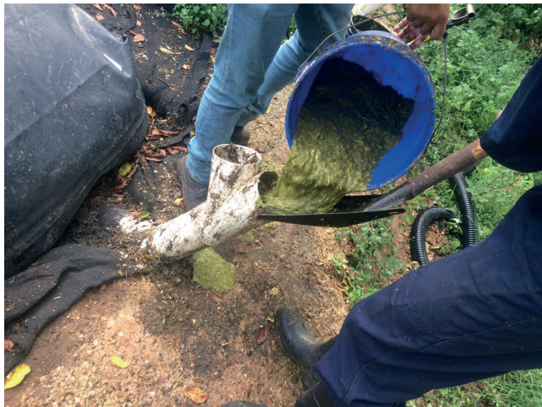
Figura 2 | Co-sustrato de planta de pitahaya triturado, aplicándose al biodigestor.
