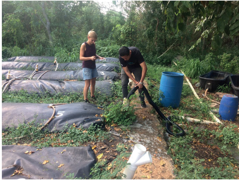
Figura 1 | Recarga de biodigestores con ARP como sustrato base.
