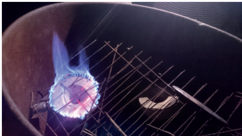
Figura 3 | Flama de referencia para el quemado de biogás.
