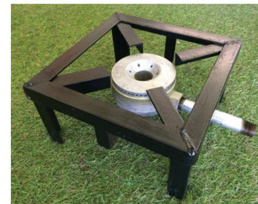
**Figura 3.** Estufa a biogás sin inyección de biogás, con eliminación de ingreso de aire primario.
