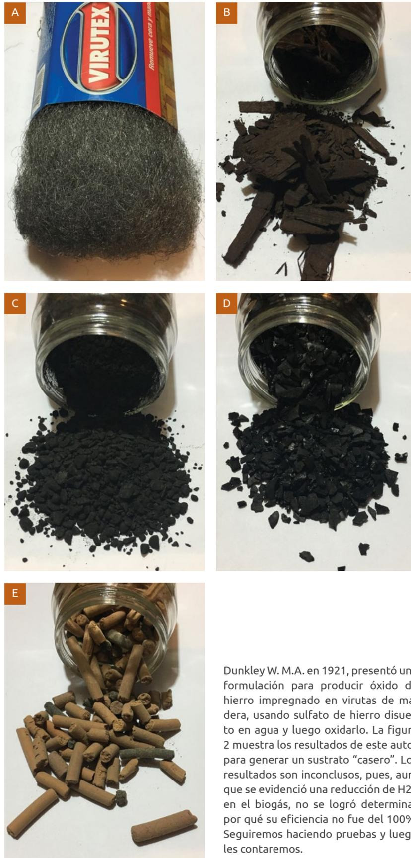
Dunkley W. M.A. en 1921, presentó una formulación para producir óxido de hierro impregnado en virutas de madera, usando sulfato de hierro disuelto en agua y luego oxidarlo. La figura 2 muestra los resultados de este autor para generar un sustrato "casero". Los resultados son inconclusos, pues, aunque se evidenció una reducción de H<sub>2</sub>S en el biogás, no se logró determinar por qué su eficiencia no fue del 100%. Seguiremos haciendo pruebas y luego les contaremos.
