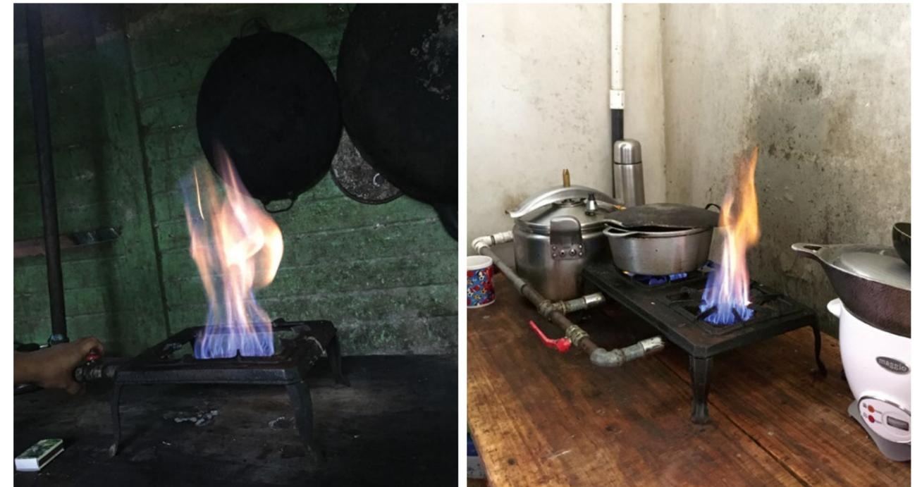
Figura 4. Estufas para la combustión de biogás.
