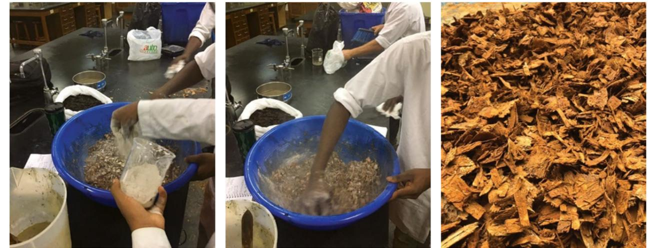
**Figura 2.** Producción de óxido de hierro impregnado en virutas de madera.
