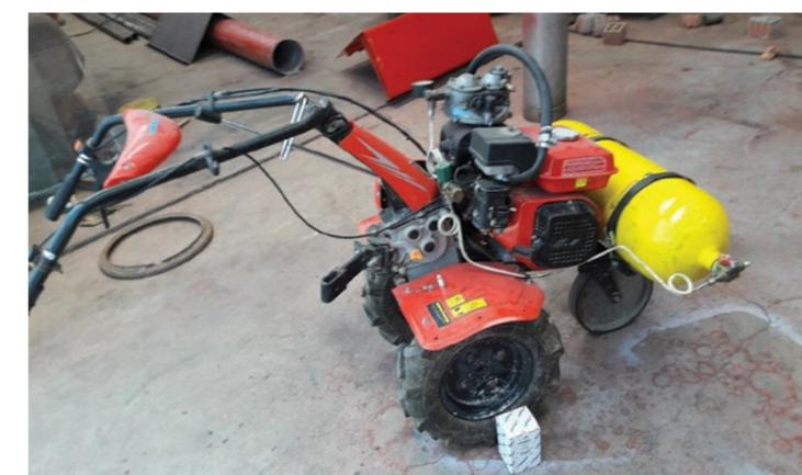
Figura 1. Tractor de 2 ruedas con motor de gasolina, adaptado para funcionar con biometano.
