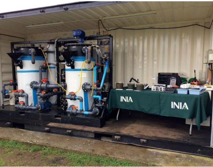
Una de las plantas, es un biodigestor de construcción pasiva a escala piloto, con un sistema de carga a través de bomba, agitación manual y sin sistema de calentamiento del reactor, el cual genera biogás que es utilizado para calentamiento de agua. La otra planta, realiza digestión anaeróbica húmeda, con un sistema multietapas, sistema automático
