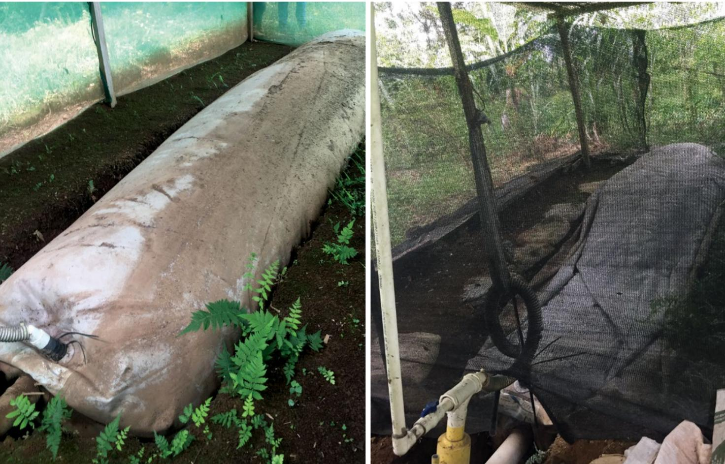
Figura 2b. Ejemplos de los biodigestores instalados.
