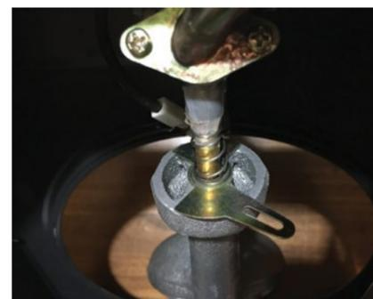
Figura 5. Ejemplificación de la apertura de la compuerta de aire primario en la estufa a biogás. Fuente: Elaboración propia
