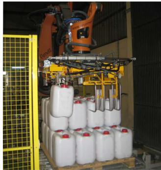
Ligne complet de paletization par robot automatique. Diferents type de pince pour: sacs, boîtes, carafes, etc.
