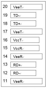
1 VeeT₽ 2 Tx Fault 3 Tx Disable₽ 4 SDA. 5 SCL₽ 6 MOD-DEF(0)₽ 7 Reset⊬ 8 SD₽ 9 RSSI-trigger⊌ 10 VeeR⊬
