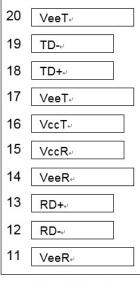
1 VeeT₽ 2 Tx Fault 3 Tx Disable₽ 4 SDA. 5 SCL₽ 6 MOD-DEF(0)₽ Reset⊬ 8 SD₽ 9 RSSI-trigger⊌ 10 VeeR⊬
