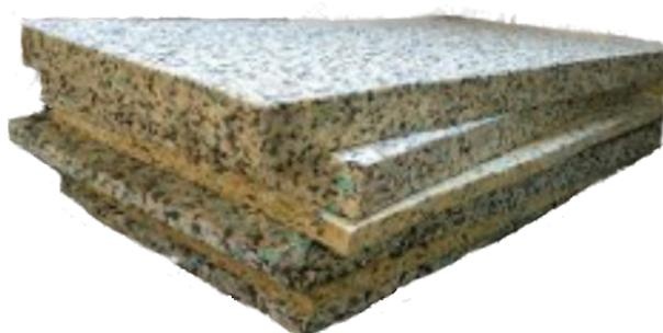
Espuma de poliuretano de Alta densidad para aislamiento Termico y acustico. Composicion de fragmentos de espuma expandida densidad promedio de 24 kg/m<sup>3</sup>, aglutinada con resina fenolica moldeada en bloques.
