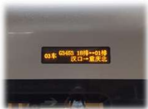
一种动车组 LED 电子式水牌
