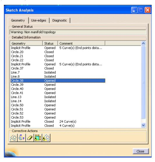
En la ficha Diagnostic vemos el tipo de creación de las líneas, arcos y puntos que conforman el sketch. Los puntos deben ser de Construction, las líneas y los arcos deben ser de Geometry, y en caso de no ser así puede ser motivo de los problemas del sketch.
