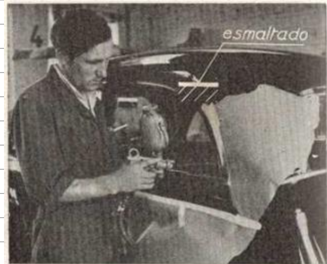
FIG. 210,6. La superficie plastecida, lijada y con capa de imprimación recibe, a continuación, la capa de esmalte
