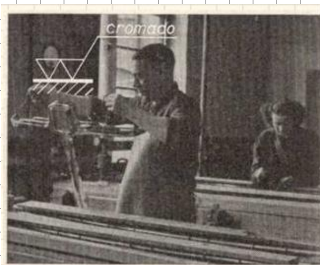
FIG. 210,4. La superficie alisada recibe tratamiento de cromado
