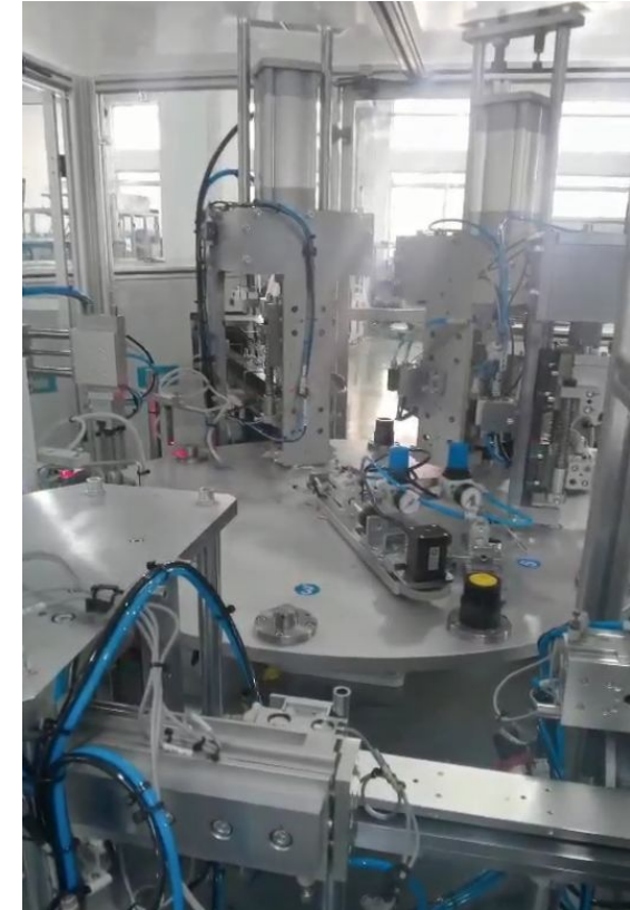
Línea de ensemble automática para tapa del roller 端盖自动组装线 Automatic assembly line for rollers' end cap
