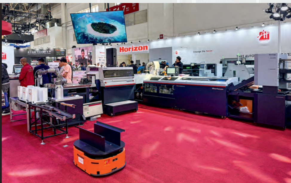
• Horizon 結合機器手臂、AGV 自走車，透過雲端 iCE LiNK 超連結完成一體化自動裝訂流程
