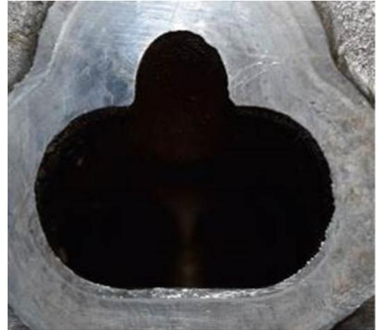
L'ajustement du conduit de culasse côté admission est interdit. Toute trace de limage, meulage, microbillage... est prohibée. Le conduit du collecteur d'admission peut être ajusté ainsi que le joint. De la matière peut être enlevée, il est interdit de rapporter du métal. Les traces d'usage correspondant à l'ajustement du collecteur d'admission à la culasse ne doivent pas dépasser 10mm de la face d'appui du joint.
