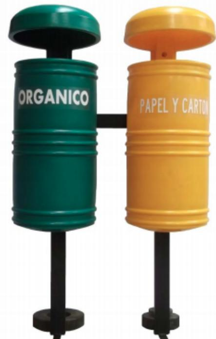
La papelera urbana PRO-70 esta fabricada en el proceso de rotomoldeo, utilizando polietileno de media densidad, lo cual le da las propiedades de absorber los impactos y ser altamente resistentes a las condiciones del clima, cuenta con protección a los rayos UV. Se puede empotrar y cuenta con llave de acceso para una mayor seguridad. Se fabrican en colores que ayudan a la clasificación de los desechos. Son de gran utilidad en parques, escuelas, calles y andadores.
