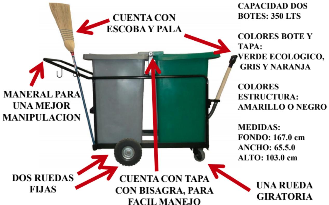
El CARRO RECOLECTOR 350 esta fabricado en el proceso de rotomoldeo, utilizando polietileno de media densidad, lo cual le da las propiedades de absorber los impactos y ser altamente resistentes a las condiciones del clima, cuenta con protección a los rayos UV. Cuenta con tapas con bisagra para fácil manejo, lleva una llanta giratoria y dos fijas para un mejor desplazamiento y un maneral para su manipulación.
