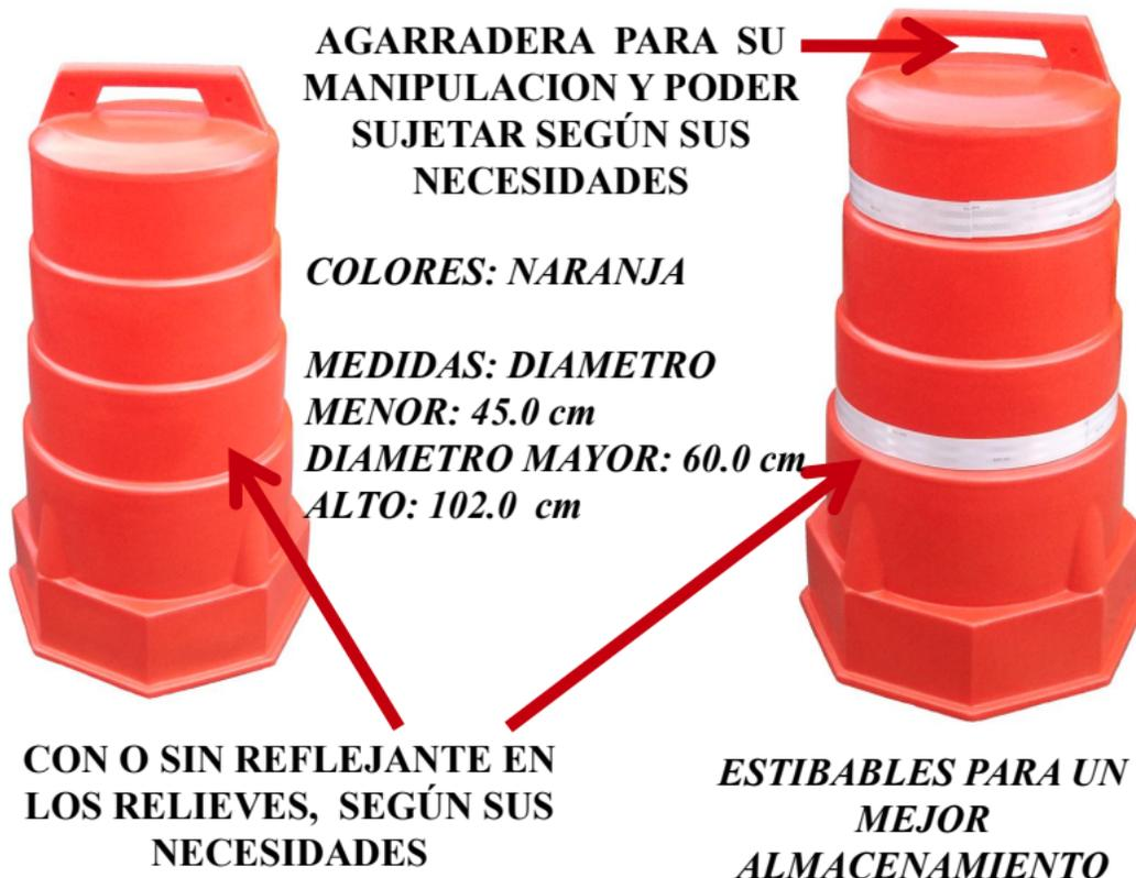
El TRAFITAMBO está fabricado en el proceso de rotomoldeo, utilizando polietileno de media densidad, lo cual le da las propiedades de absorber los impactos y ser altamente resistentes a las condiciones del clima, cuenta con protección a los rayos UV. Su diseño es especial para delimitar áreas en lugares laborales o de nuestra ciudad.
