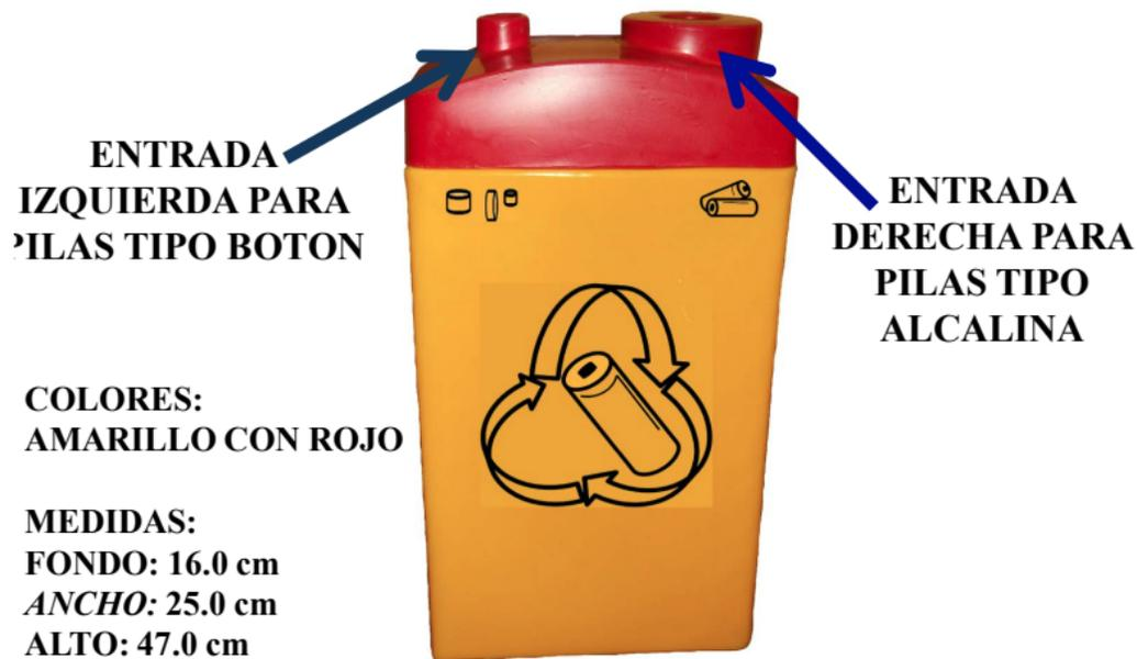
La papelerera CONTENEDOR PRO-BATTERY esta fabricado en el proceso de rotomoldeo, utilizando polietileno de media densidad, lo cual le da las propiedades de absorber los impactos y ser altamente resistentes a las condiciones del clima, cuenta con protección a los rayos UV. Hecho especialmente para pilas usadas, cuenta con doble compartimento y entrada, izquierda para pilas tipo boton y derecha para pilas tipo alcalinas. Son de gran utilidad para escuelas, centros comerciales y empresas.
