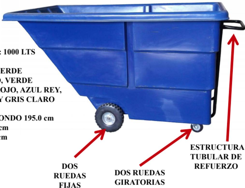
El volteo PRO-1000 esta fabricada en el proceso de rotomoldeo, utilizando polietileno de media densidad, lo cual le da las propiedades de absorber los impactos y ser altamente resistentes a las condiciones del clima, cuenta con protección a los rayos UV. Fácil vaciado inclinable al frente, cuenta con estructura tubular de refuerzo. Se fabrican en colores que ayudan a la clasificación de los desechos y/o equipo de trabajo. Son de gran utilidad en hospitales, hoteles e industria en general.
