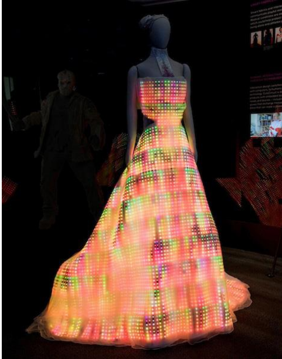
Resim 347; Chicago'daki Bilim ve Sanayi Müzesindeki gösteride Cute Circuit üzerinde Galaxy Dress vardı. Bu büyüleyici giysi 24,000 LED içerir ve teknik tekstilin gerçekten çarpıcı bir parçasıdır. Giysi 2mm ye 2mm LEDlerin ipek bir şifon ve organza krolin kumaşa dokunması ile yapılmıştır. Bu giysiyi daha fazla ışık verir ve giyilebilir yapılmıştır. Enerji giysinin içine saklanmış olan pek çok iPod pilinden gelmektedir.
