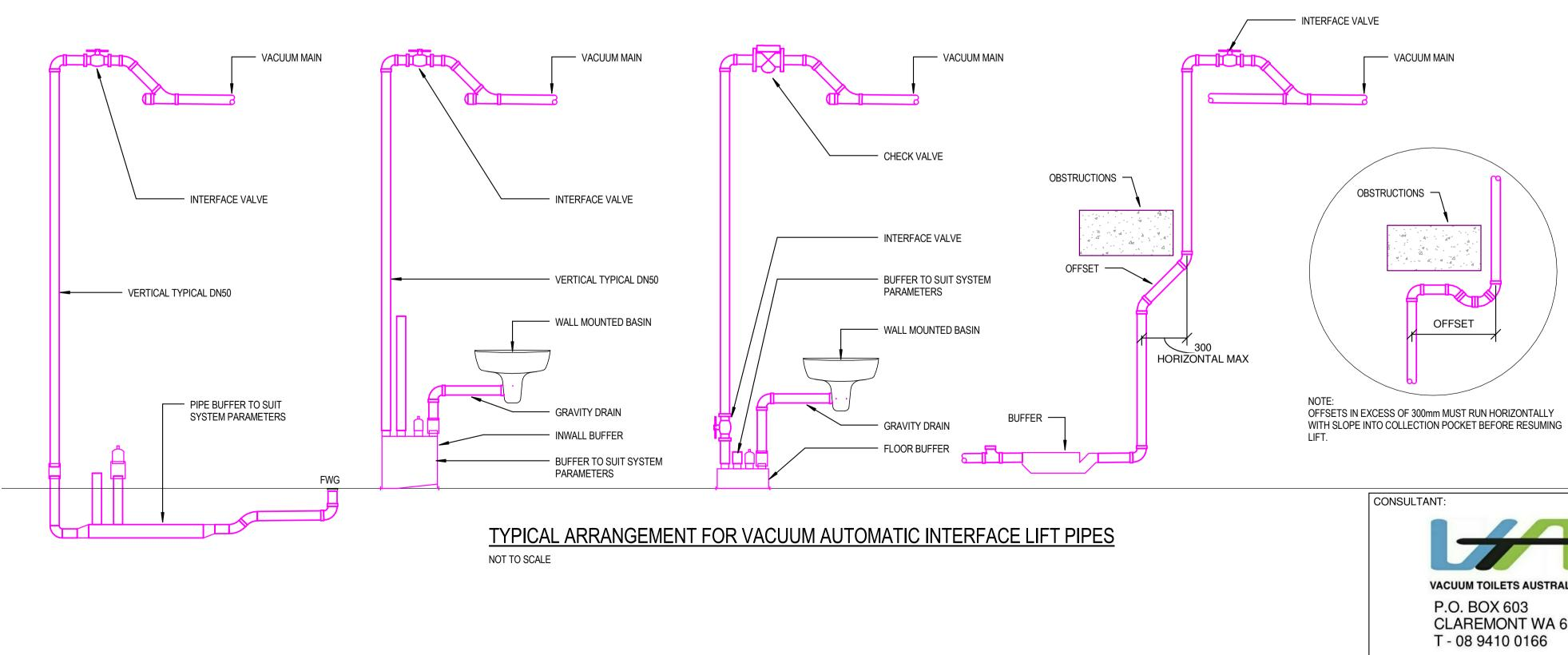
TYPICAL MULTI LEVEL VACUUM DRAINAGE SYSTEM NOT TO SCALE
