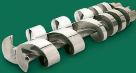
Herzstück der Füllmaschinen sind die VEMAG Förderkurven. Auf besonders schonende Weise und ohne Kompressionszone transportieren sie auch Rohstoffe mit großstückigen Einlagen vom Einlauf zum Auslauf der Maschine. Der Rohstoff wird nicht gestresst und schonend transportiert: denn so sehen Ihre Produkte richtig zum Anbeißen aus. Die Förderkurven arbeiten nahezu
