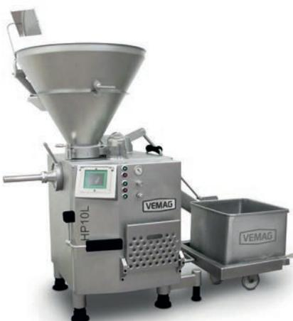
Die HP10L ist der Abdrehspezialist mit Förderkurve für den flexiblen Einsatz. Die Lösung für alle Füllaufgaben in der Würstchenproduktion ohne Füllwolf. Ihr Können kommt besonders mit Darmhaltevorrichtungen oder den VEMAG Flexible Sausage Lines zum Vorschein. So ist das Abdrehen und Portionieren auch weicher Massen ein Kinderspiel.
