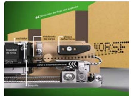
Funciona mediante la expulsión de gotas de tinta que son transportadas mediante un campo eléctrico desde un inyector del cabezal de impresión hasta la superficie del material que se desea imprimir.
