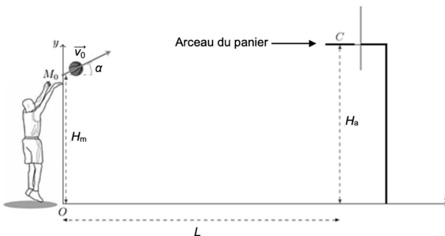
On étudie le mouvement dans le repère cartésien indiqué sur la figure 1 : le plan  $(Oxy)$  est un plan vertical contenant la main du basketteur au moment où il lâche le ballon et le centre  $C$  de l'arceau.
