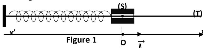
On comprime le ressort de  $2 \text{ cm}$ , puis on communique au solide une vitesse initiale  $\vec{V}_0$  de norme  $V_0 = 0,35 \text{ m.s}^{-1}$  à l'instant de date  $t = 0\text{s}$ .
