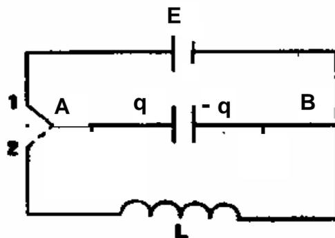
**10.1** Etablir la relation liant la charge  $q$  du condensateur à sa dérivée seconde  $\ddot{q}$ ,  $L$  et  $C$ .
