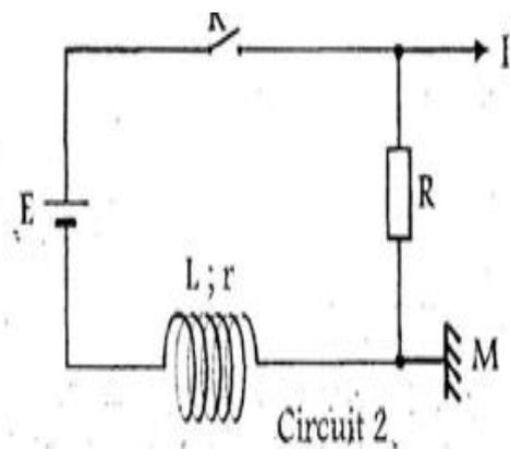
A  $t = 0$ , on ferme les interrupteurs  $K$  des deux circuits et à l'aide de deux oscilloscopes à mémoire bicourbe, branchés convenablement on obtient les courbes (a) et (b) représentées sur un même graphe.
