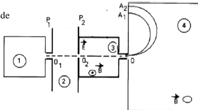
Afin de sélectionner une seule vitesse  $\vec{v}_0$  en O, on impose aux ions, dans le filtre de vitesse (chambre 3) un champ magnétique  $\vec{B}$  et un champ électrique  $\vec{E}$  comme l'indique la figure.
