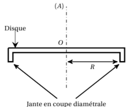
1. Le moment d'inertie  $J$ , du plateau par rapport à l'axe  $(\Delta)$  est  $J = 2,25 \times 10^{-2} \text{ SI}$  (on précisera l'unité). Calculer l'énergie cinétique du plateau tournant à  $\frac{100}{3} \text{ trs/min}$  et la vitesse linéaire d'un point situé à sa périphérie. **(0,25 pt + 0,25 pt)**
