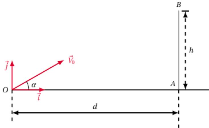
Le joueur, tirant le coup franc, communique au ballon une vitesse initiale  $\vec{V}_0$  dans le plan  $(O, \vec{i}, \vec{j})$ , inclinée par rapport à l'horizontale d'un angle  $\alpha = 30^\circ$
