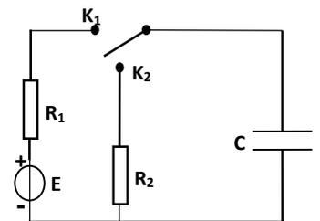
**II/ Etude de la décharge du condensateur dans le résistor R2:**
