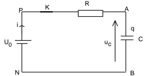
Soient  $\tau$  la constante de temps du circuit et  $\tau_r$  (temps de relaxation) le temps mis par le condensateur pour se charger quasi totalement (à 99%). Montrer que  $\tau_r = 4,6 \tau$ .
