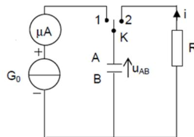
Un dispositif (non représenté) relève à intervalles de temps réguliers, la tension  $u_{AB} = u_c$  aux bornes du condensateur.
