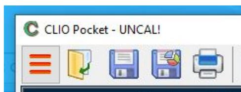
Nella figura mostrata sopra, il software informa che non è stato calibrato o che necessita di essere calibrato. Questo è lo stato predefinito al primo avvio di CLIO
