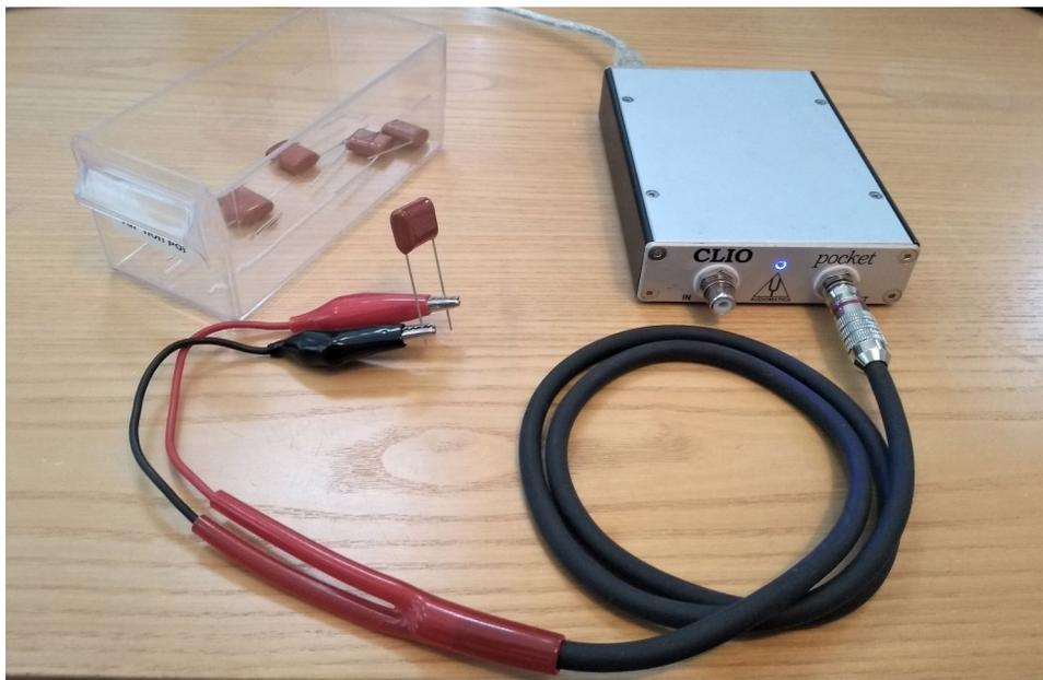
Premendo il bottone con la freccia ► dovrebbe apparire la misurazione in tempo reale del valore del componente.
