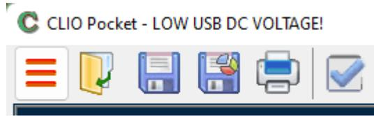
Questo può essere causato da un funzionamento non corretto del cavo USB o/e della porta USB del PC. Il fatto che lo stesso cavo USB o/e porta USB del PC funzioni con altri dispositivi non garantisce il fatto che la tensione DC fornita dalla porta USB sia sufficiente al funzionamento dell'hardware CLIO Pocket CP-01.
