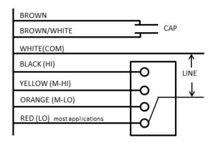
THE WIRING DIAGRAM SHOWS THE SPEED SELECTION WIRE COLORS FOR THE 4 SPEED MOTOR.
