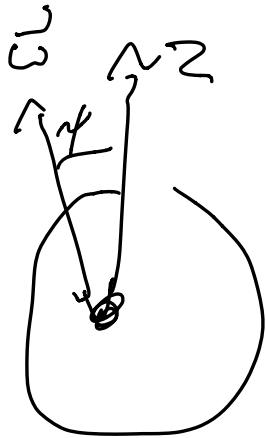
$$\vec{\omega} = (\omega \sin \varphi, 0, \omega \cos \varphi)$$
